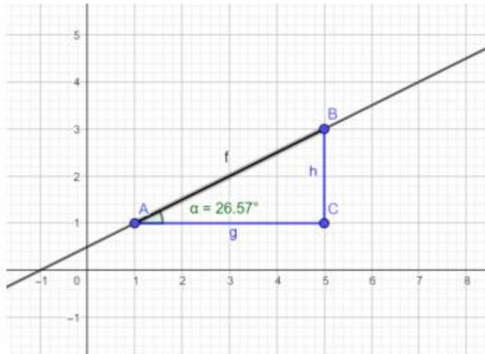
Na figura,  $m = \operatorname{tg}(\alpha) = \frac{h}{g} = \frac{(y_B - y_A)}{(x_B - x_A)} = \frac{(3-1)}{(5-1)} = \frac{1}{2}$ , em que  $m$  é o coeficiente angular.
